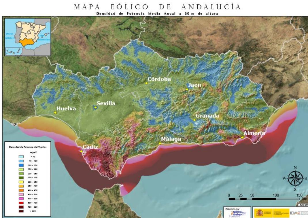
Figura 1. Densidad de potencia media anual a 80 metros de altura. Fuente: Instituto para la Diversificación y el Ahorro de Energía (IDAE).
