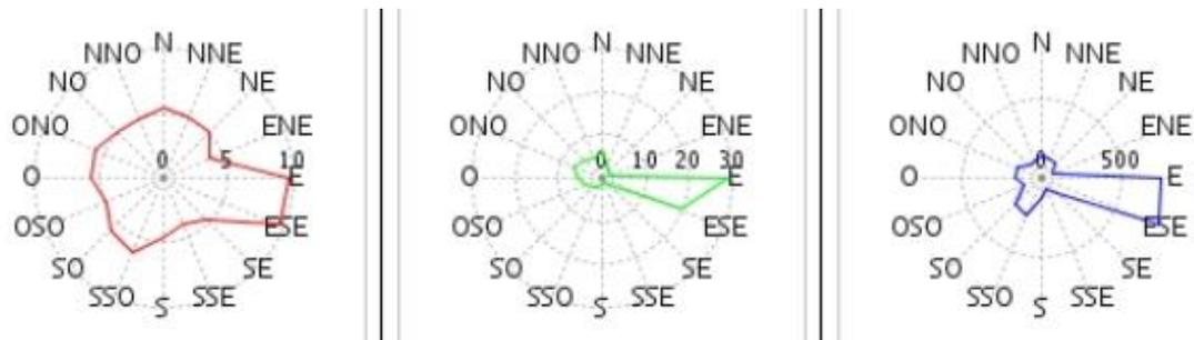
Figura 5. Rosa de los vientos de velocidad media, frecuencia y potencia. Fuente: AAE.
