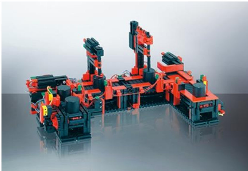
Ilustración 11: LÍNEA INDEXADA CON DOS UNIDADES DE MECANIZADO
