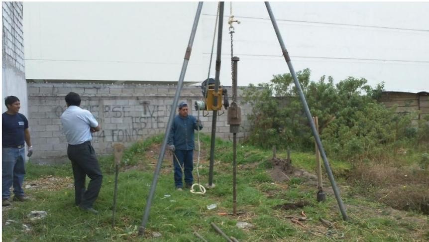
*IMAGEN 1 – PENETRACIÓN DINÁMICA EN PROSPECCIÓN 1*
