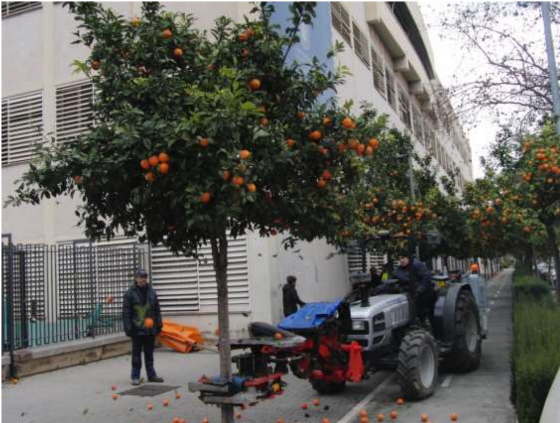
Figura 3. Vibrador de troncos marca Topavi vibrando un naranjo ornamental (Fuente: Antonio Torregrosa)
