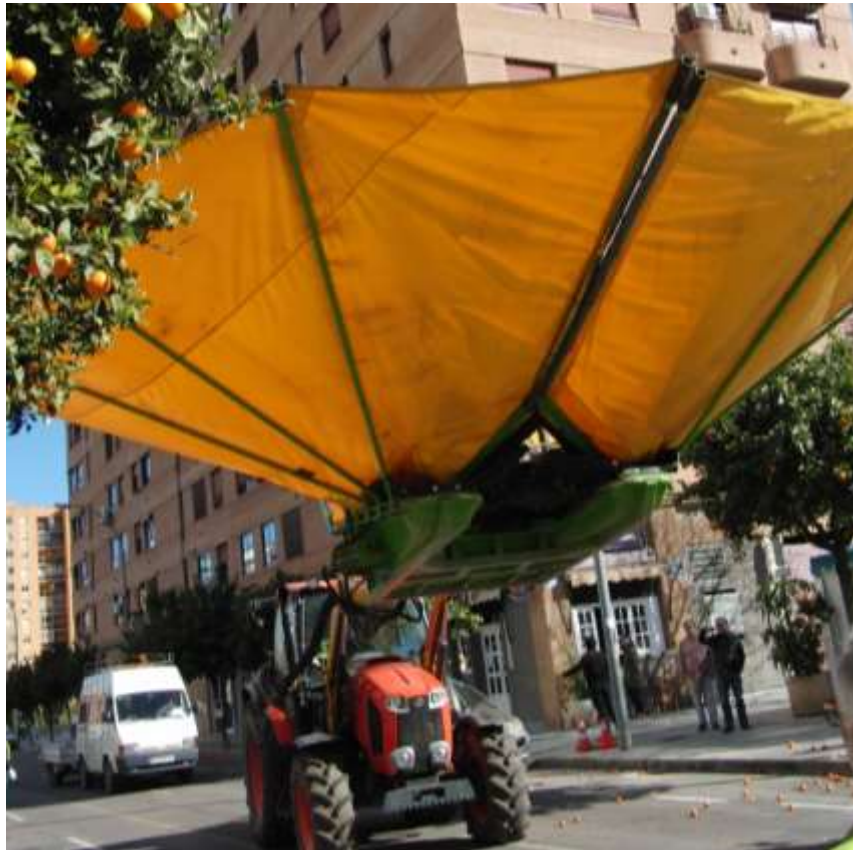
Figura 4. Vibrador de troncos marca Estupiña con paraguas provisto de varas de 3 m (Fuente: Antonio Torregrosa)
