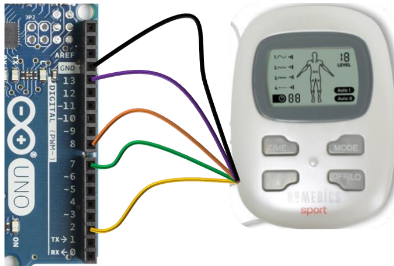
Figura 37: Esquema de conexiones electroestimulador HoMEDICS-Arduino UNO
