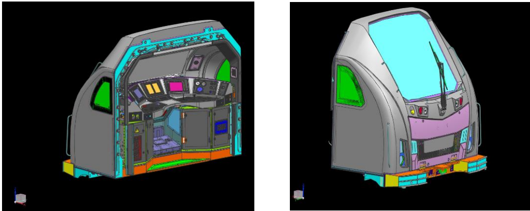
Imagen 2 Diseño 3D Cabina y Bastidor Locomotora. (Stadler Rail Valencia S.A.U., 2017)
