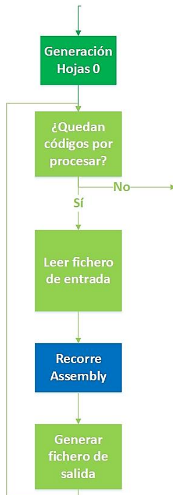
Figura 5 Diagrama de flujo de Generación Hojas 0 (Fuente: Elaboración propia).
