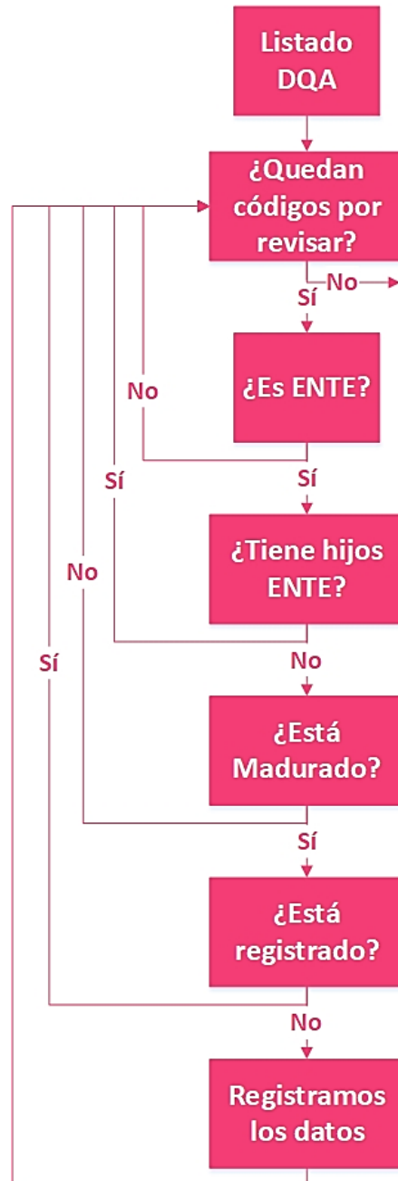
Figura 10 Diagrama de flujo de “Listado DQA” (Fuente: Elaboración propia).
