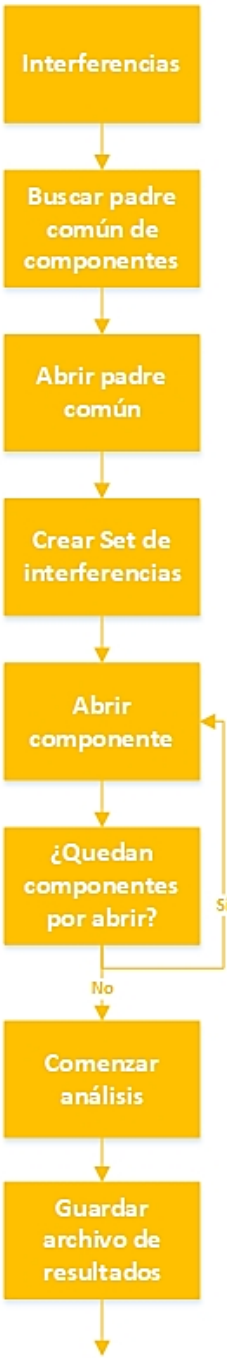
Figura 8 Diagrama de flujo de “Interferencias” (Fuente: Elaboración propia).
