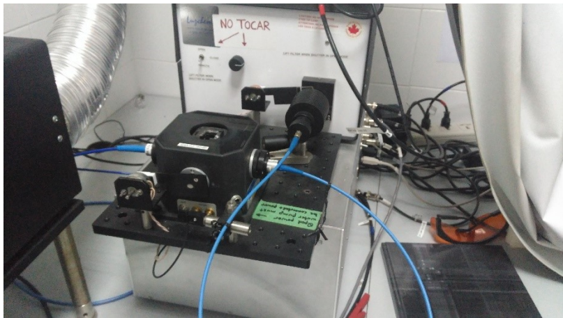
Ilustración 13. Módulo LFP, porta-cubetas, fibra óptica, lámpara de Xenón y conducto de ventilación.
