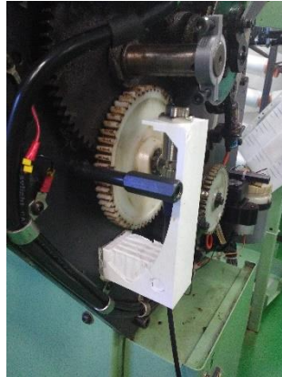
F.8 Sensor inductivo con anillo con diente metálico en la máquina
