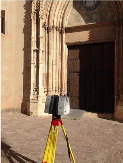
Fig.37\_ Escáner laser en la estación nº3.
