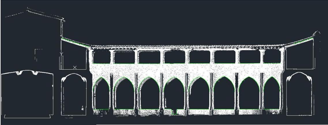
Fig.61\_ Sección dónde se obtiene forma y dimensión de los arcos y altura de muretes del alzado norte del claustro.
