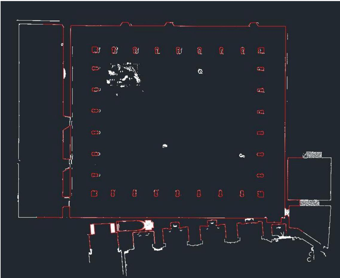
Fig.59\_Sección horizontal cota 2.00 en el programa AutoCad, ya grafiada.
