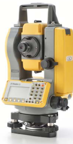
Fig. 1.1. Estación total. Instrumento utilizado. Fuente: Buscador Google
