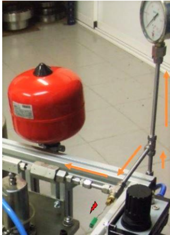
Figura 5. 5: Manómetro y termopar de la instalación experimental.
