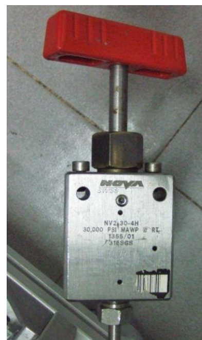
Figura 4. 27: Válvula de seguridad del depósito de AP.
