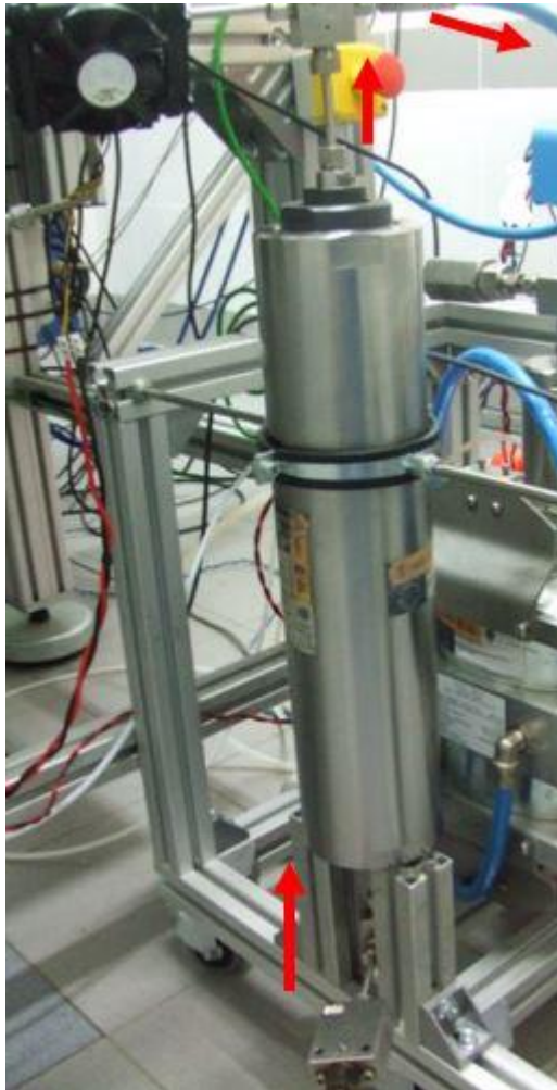
Figura 5. 7: Montaje del depósito de AP.
