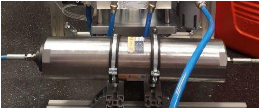
Figura 4. 22: Foto tomada al acumulador hidráulico de alta presión.
