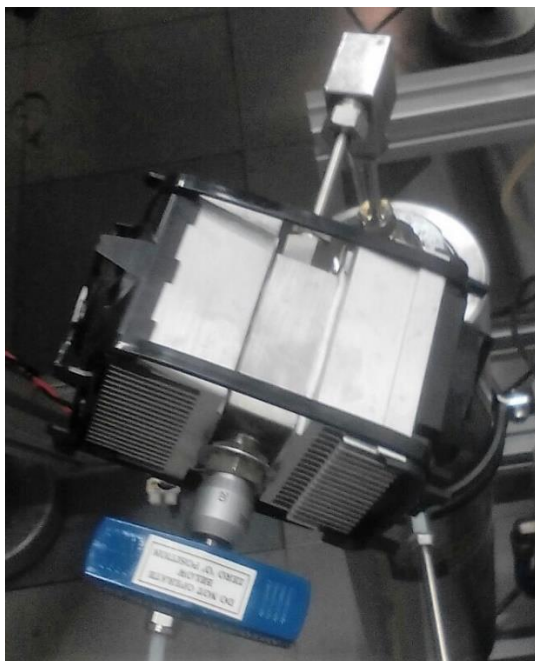
Figura 4. 26: MicroMetering equipada con dos ventiladores.
