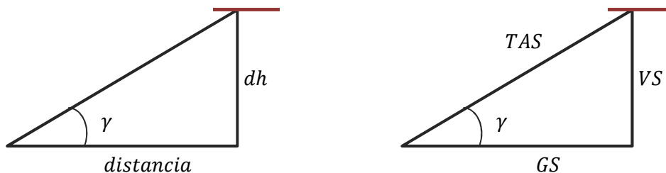
Figuras 2.2 y 2.3. Pendiente y velocidad vertical para cumplir con las restricciones de altitud de la SID.
