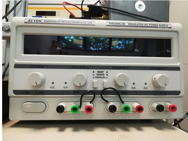
Figura 12. Fuente de alimentación TPR 3005-3C.
