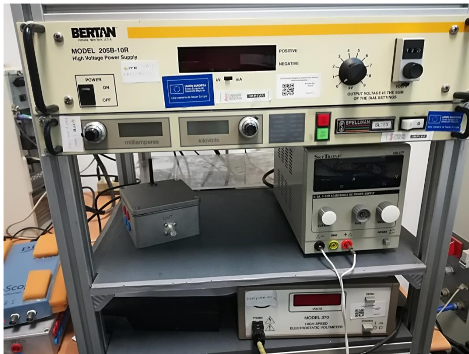
Figura 7. Montaje formado por fuente Bertan, fuente Spellman y voltímetro electrostático.
