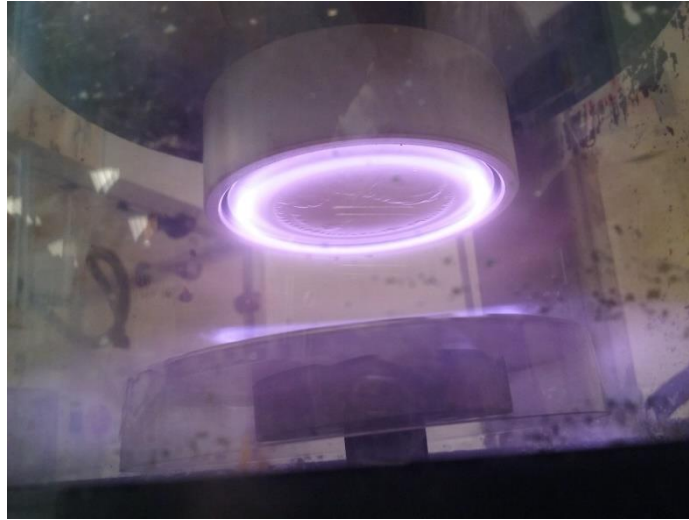
Figura 21. Metalización en acción.
