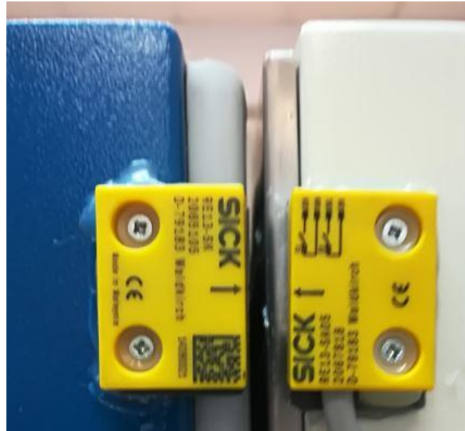
Figura 10. Enclavamientos de seguridad.
