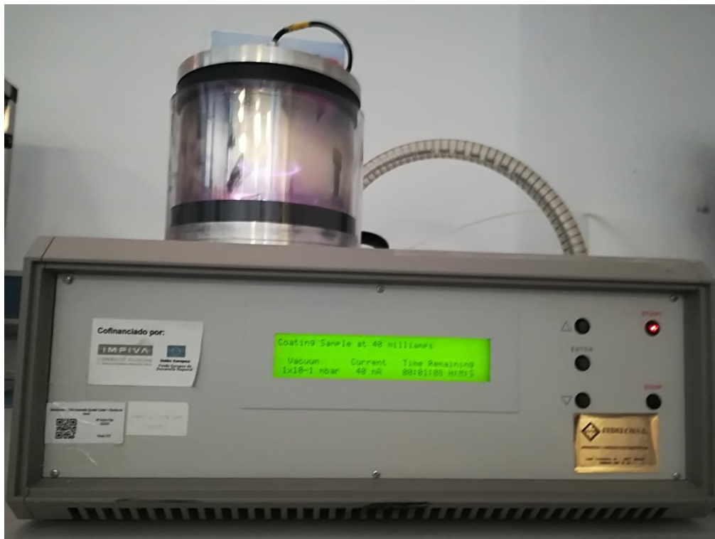
Figura 20. Metalizador Fedelco modelo k550
