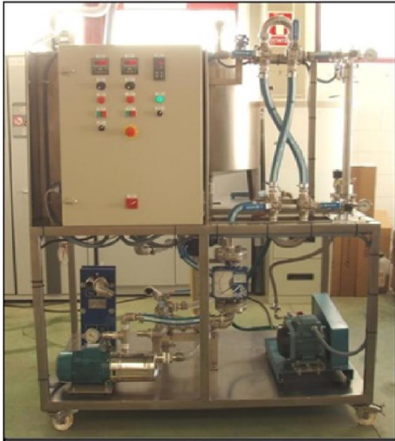
FIGURA 6. PLANTA PILOTO EN LA QUE SE REALIZAN LOS ENSAYOS DE SEPARACIÓN CON LAS MEMBRANAS DE ULTRAFILTRACIÓN.
