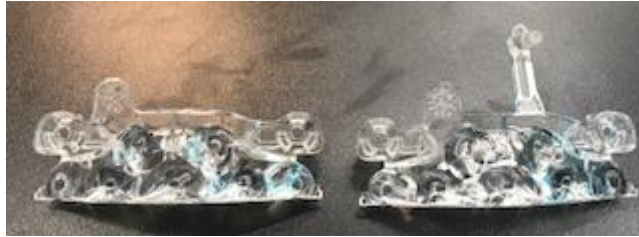
Figura 4.27 Primeras muestras, a la derecha tras el corte de bebedero e izquierda con bebedero
