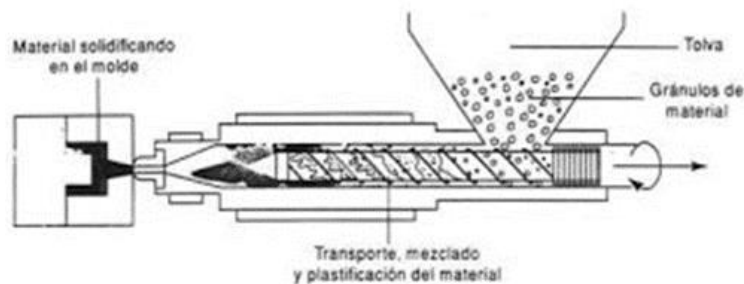
Figura 2.21 Detalle de la etapa de solidificación en el molde
