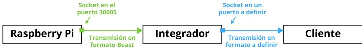
Figura 5.8: Esquema resumen de las conexiones del sistema.
