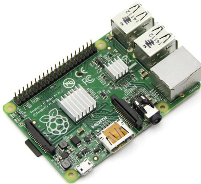
Figura 6.2: Raspberry Pi B+ con los disipadores montados.
