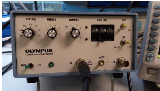
Figura 58. Generador/Receptor de pulsos Olympus 5072PR
