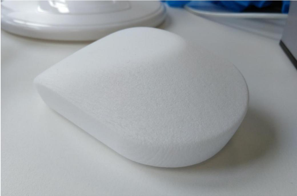
*Ilustración 116 Ratón fabricado en SLS*
