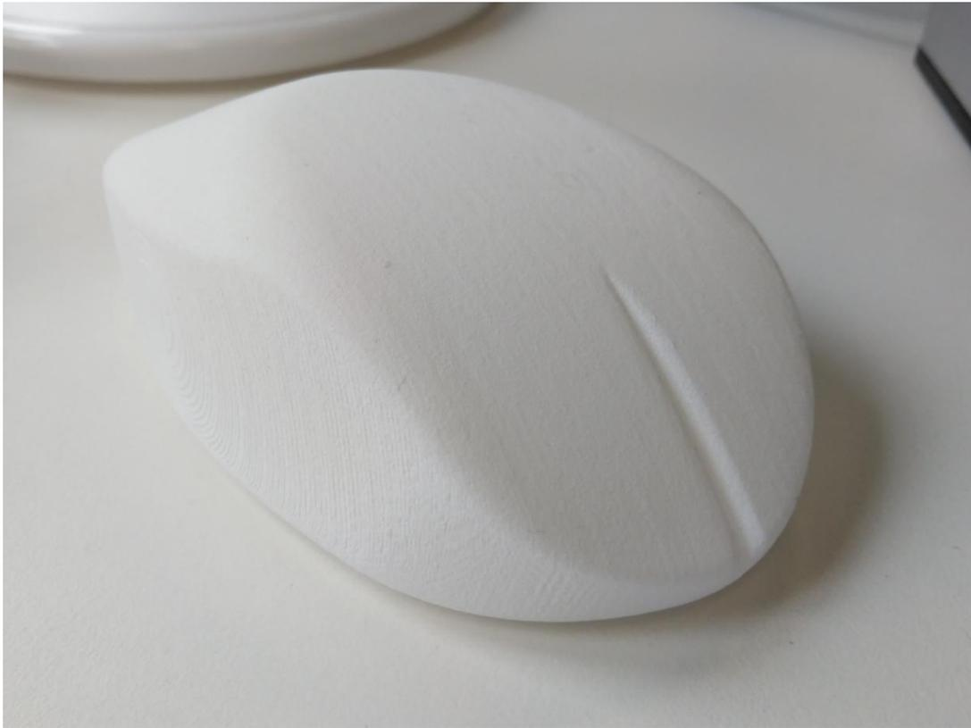
*Ilustración 118 Ratón fabricado en SLS*
