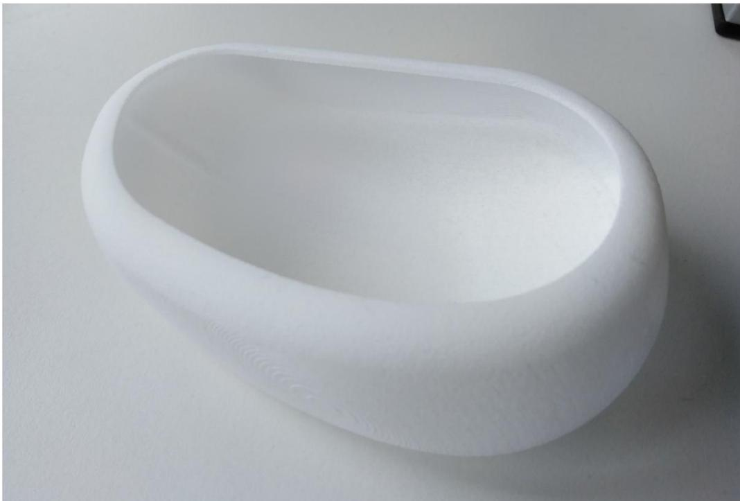
*Ilustración 117 Ratón fabricado en SLS*
