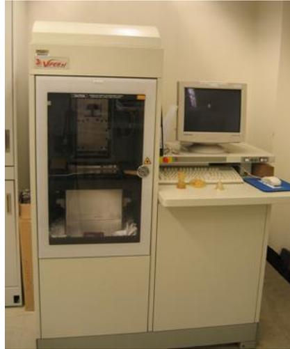
*Ilustración 16 SLA 3DSystems viper si2*
