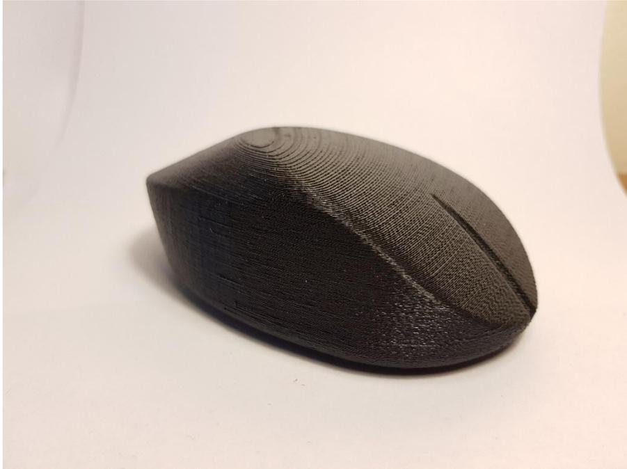
*Ilustración 104 Fabricacion Fdm reconstrucción NX*
