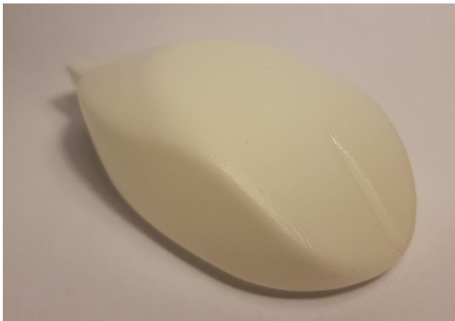
*Ilustración 110 Modelo reconstrucción NX fabricado en SLA*
