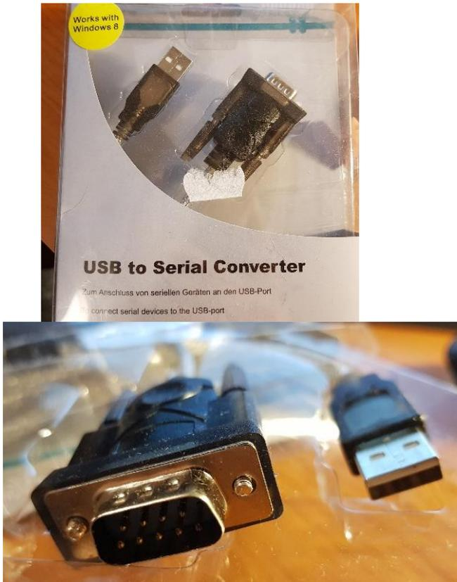
*Ilustración 11 Conector USB To RS 232 C*
