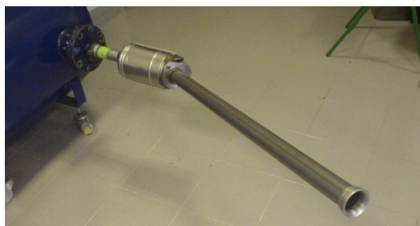
Figura 4.1: Montaje de la instalación del banco de flujo.
