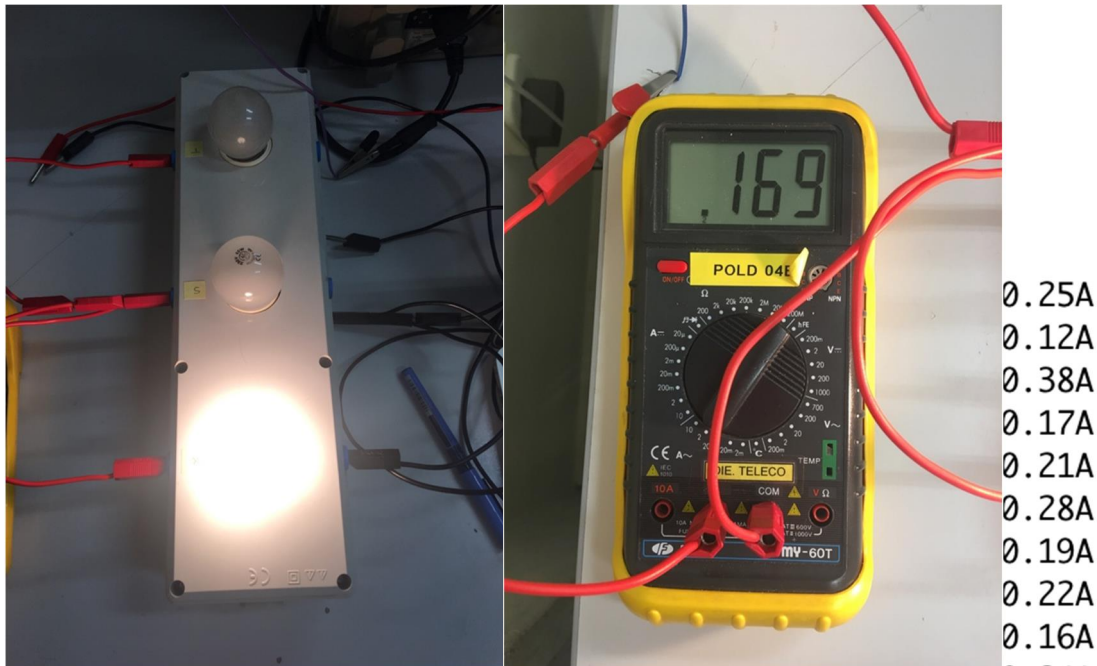
Figura 29. Imágenes de intensidad real, estado de las bombillas y medidas de la intensidad por la placa (III).
