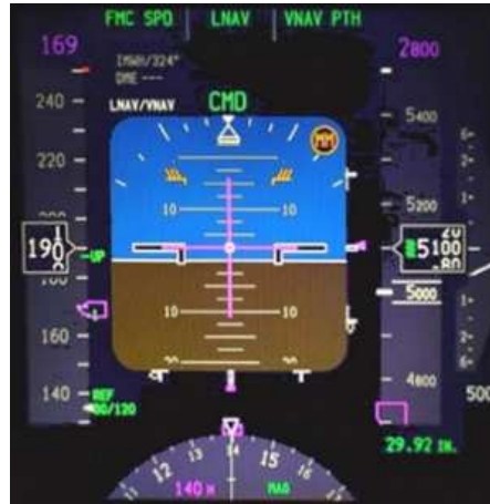
Figura 9: Display en cabina del PFD.
