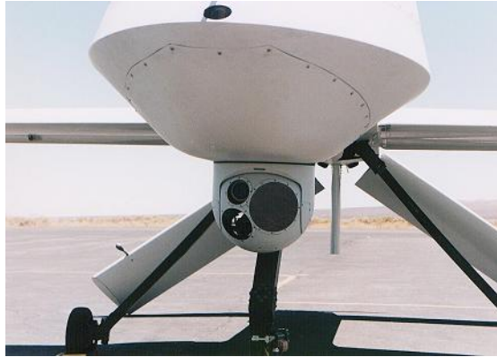
Figura 28: Detalle de la cámara del MQ-1 Predator
