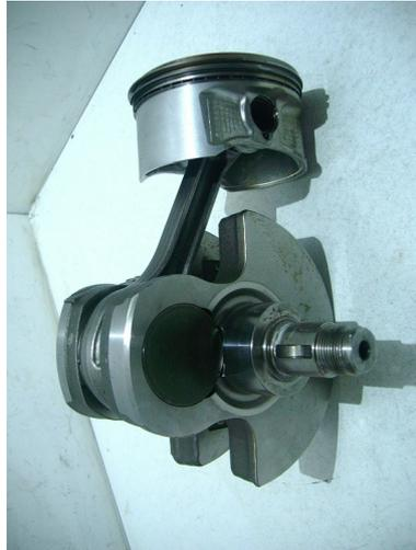
Fig. 2.6: Mecanismo pistón-biela-manivela. *Imagen: motoirun.es*
