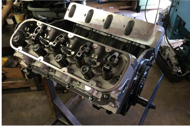
Fig. 2.4: Detalle de la distribución de una bancada en un motor de 8 cilindros en V. *Imagen: hotrod.com*
