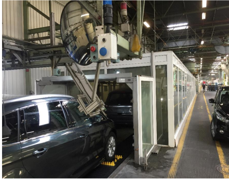
Figura 6. Prueba de estanqueidad en Water test.
