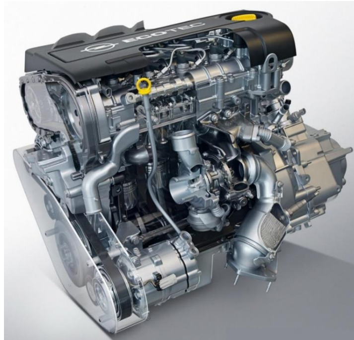
Figura 2. 3. Motor GM Z19DTH. Fuente: Opel.
