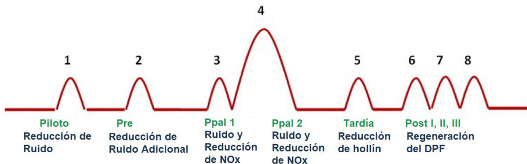
Figura 1. 3. Estrategia de inyección múltiple con el objetivo de cada inyección. Fuente: Autor.
