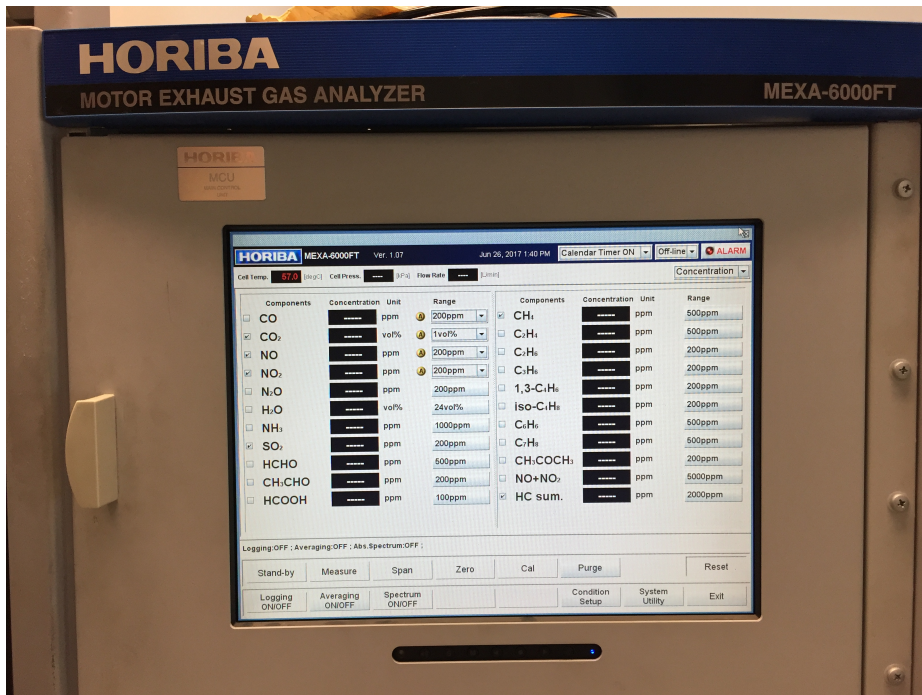
Figura 4.21. Interfaz del analizador Horiba MEXA-6000FT.
