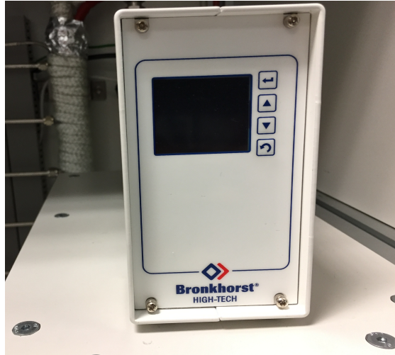
Figura 4.6. Unidad de control Bronkhorst del CEM.
