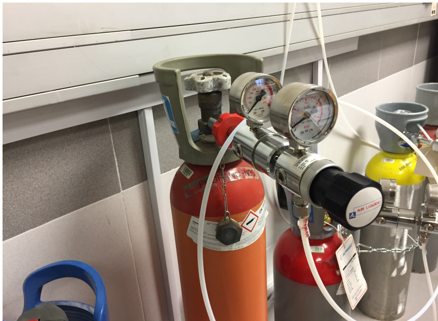
Figura 4.15. Manorreductor de Air Liquide de doble etapa.
