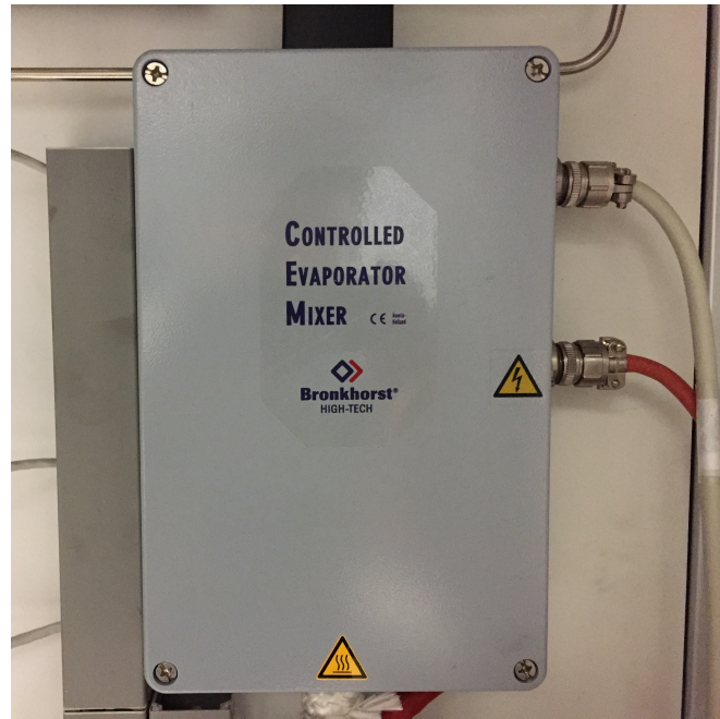
Figura 4.3. Unidad del “Controlled Evaporator Mixer” instalada en el banco.
