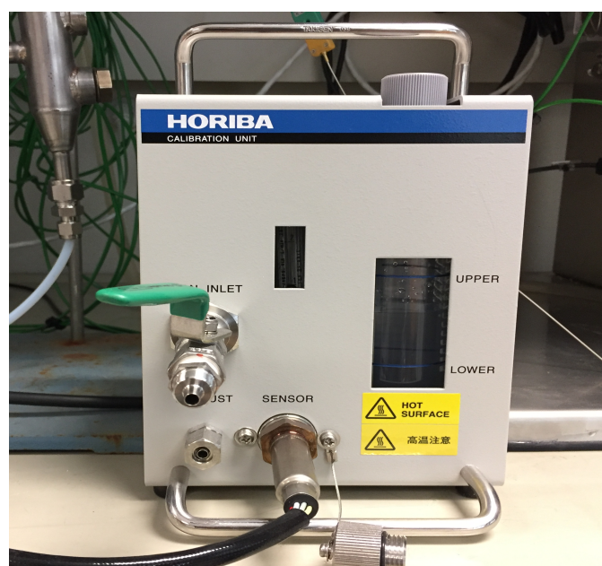
Figura 6.4. Unidad de calibración de Horiba.
