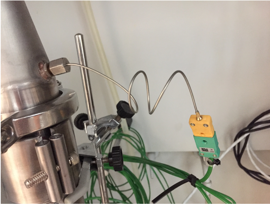
Figura 4.23. Termopar instalado en el reactor.
