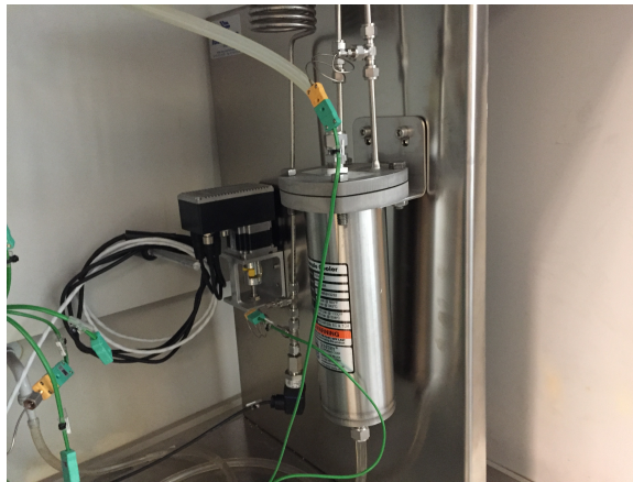
Figura 4.11. Circuito de refrigeración por agua.
