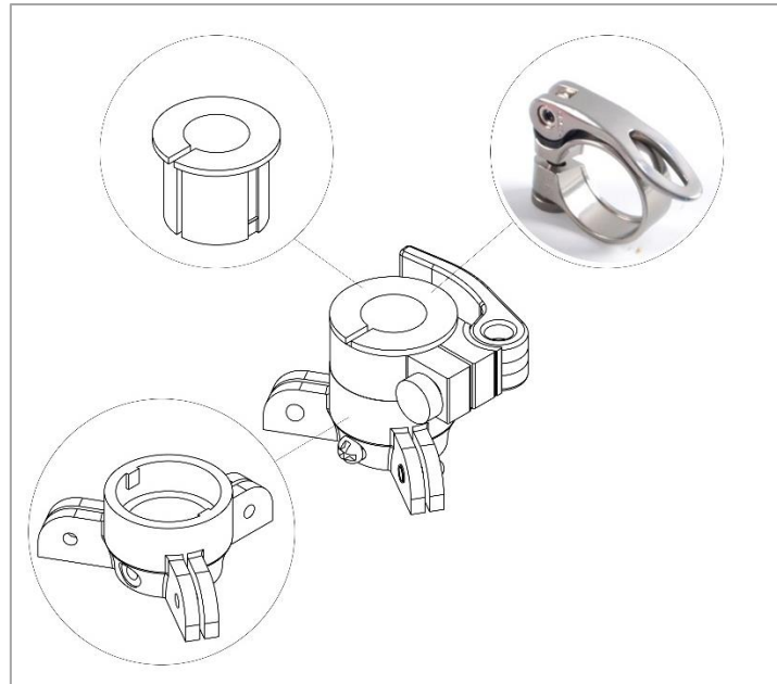
[Figura 150, esquema de la solución adoptada para el sistema corredero de fijación de alturas. Elaboración propia]
