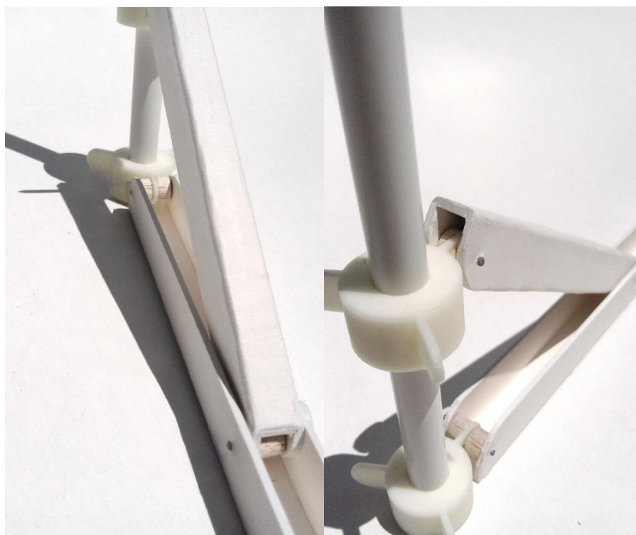
[Figura 117, fotografías de detalle de una pata de la maqueta del modelo 5.1.1 en las que se muestra la utilización de piezas de intermedias. Elaboración propia]
