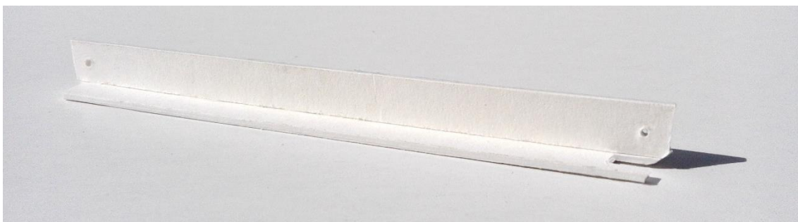
[Figura 107, fotografía de una escuadra de la pata de la maqueta del modelo 3.2.1 en la que se muestran los mecanizados que serían necesarios para hacer el modelo viable. Elaboración propia]
