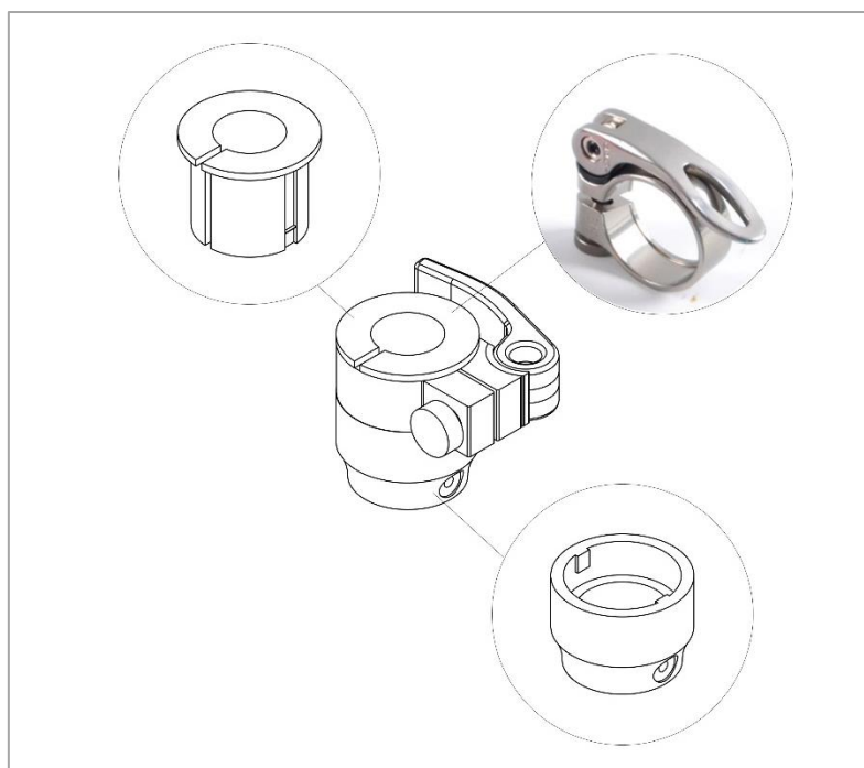
[Figura 143, esquema de la solución adoptada para el sistema de fijación de alturas. Elaboración propia]
