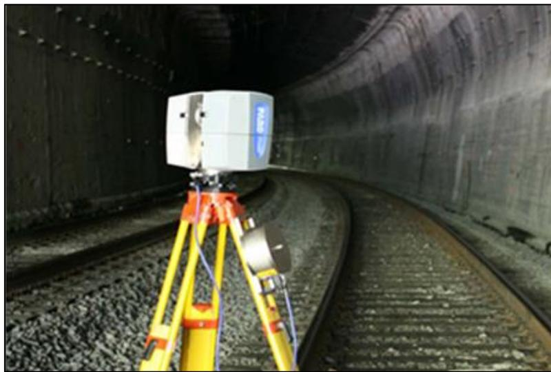
*Fig.62. Láser escáner. Fuente: faro.com.*
