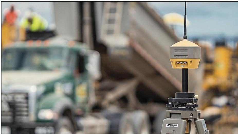
Fig.61. Receptor GNSS. Fuente: geincorl.com.
