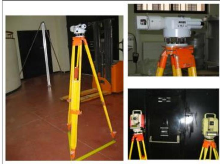
Fig.78. Equipos topográficos para el control de deformaciones (estación total, nivel).
