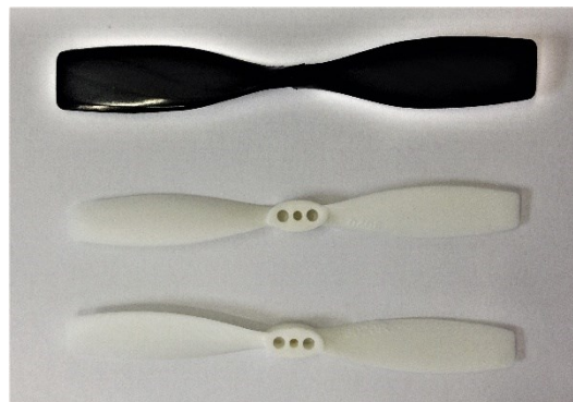
Figura 13 Hélice antigua (Arriba) y hélices RX2030 (Abajo)
