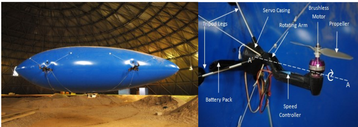
Figura 3 MkII ALTAV (izq.) y detalle de uno de los brazos de la propulsión (der.) [12]
