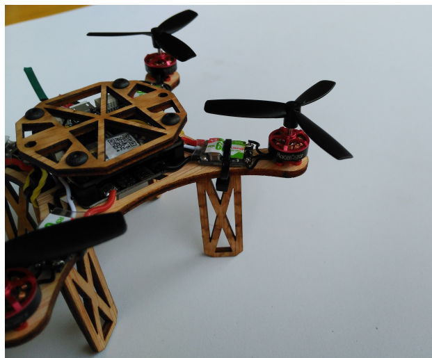
Figura 4.10: Brazo del dro cuadricóptero sin alas. (Fuente: Propia)
