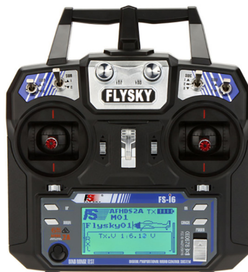
Figura 2.11: Transmisor modelo FlySky con 6 canales y frecuencia de 2.4 GHz. (Fuente: www.rctecnic.com )
