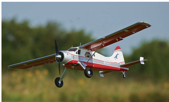
Figura 2.9: Avión de radiocontrol con tren de aterrizaje en disposición convencional. (Fuente: www.easyrc.com )
