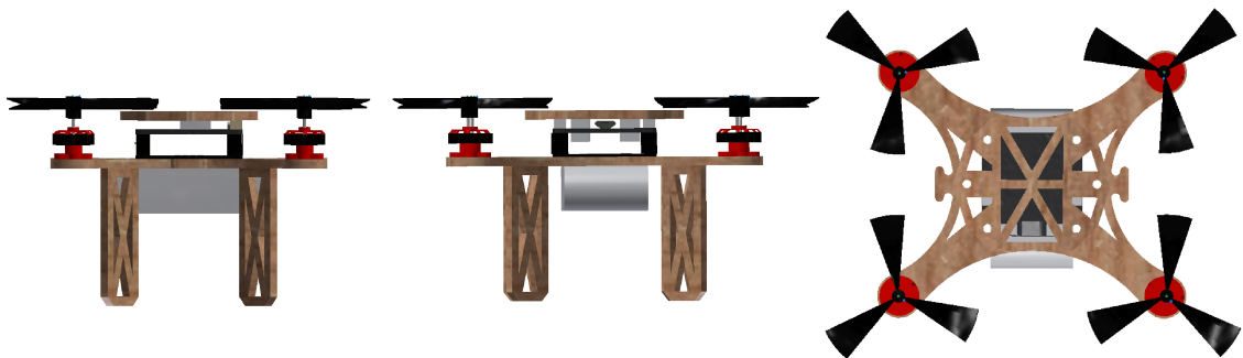
Figura 3.40: Planta, alzado y perfil (derecha a izquierda) del modelo CAD del dron cuadricóptero sin las alas. (Fuente: Propia)
