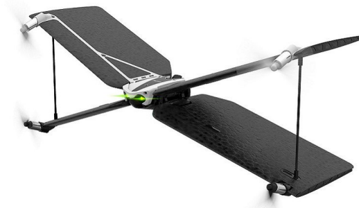
Figura 3.1: Dron cuadricóptero con alas modelo Parrot Swing. (Fuente: www.Parrot.com )
