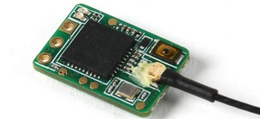
Figura 3.18: Receptor modelo FR Sky XM . (Fuente: www.hobbyking.com )
