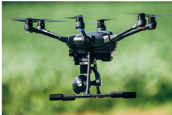
Figura 2.5: Dron hexacóptero de la compañía Yuneec modelo Typhoon H Pro. (Fuente: www.latam.pcmag.com )
