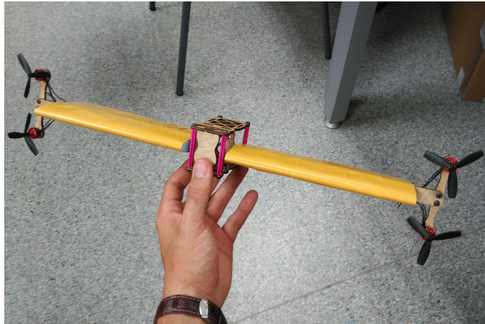
Figura B.3: Modelo de dron desechado por peso excesivo. (Fuente: Propia)
