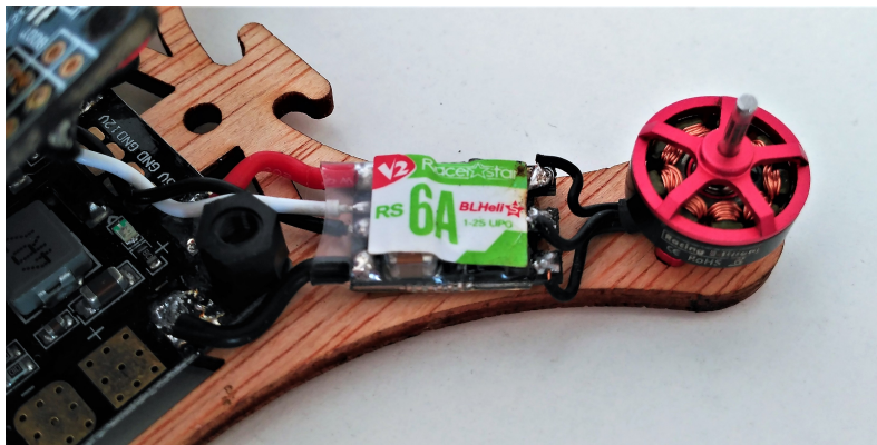
Figura 4.3: Soldadura de los ESCs. (Fuente: Propia)
