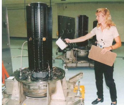
Figura 1.6: RTG instalado en sonda Cassini durante un test de radiación con un contador Geiger, [9].
