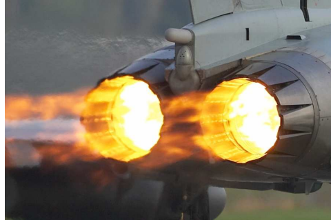
Figura 1.5: Las altas temperaturas de la turbina o el post-quemador podrían ser aprovechadas por los dispositivos termoelectricos para generar potencia eléctrica, [8].
