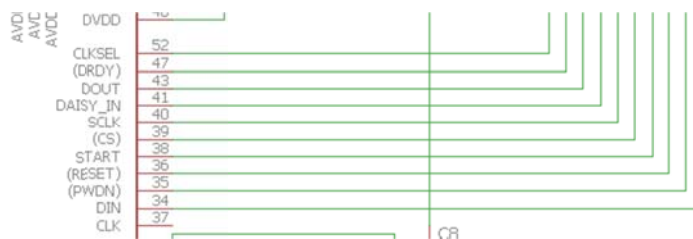
Figura30. Pines de entrada y salida digital comunicación con el microcontrolador PIC. Vista en detalle de la conexión de los pines digitales de conexión con PIC
