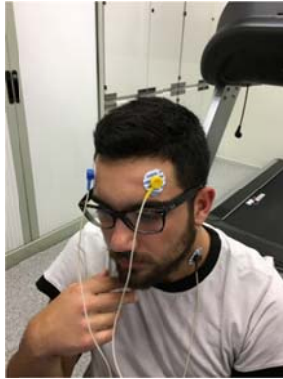
Figura55. Colocación de los electrodos para las medidas de electroencefalografía de cada uno de los canales.
