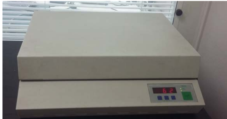
Figura33. Máquina insoladora con prensa de vacío utilizada para la creación de la placa de circuito impreso.
