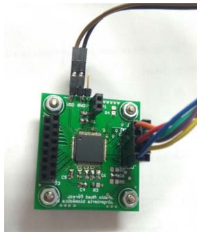
Figura36. Aspecto de la placa tras la soldadura de los componentes y los cables de conexión SPI, así como los de alimentación y masa (marrón y negro, respectivamente)
