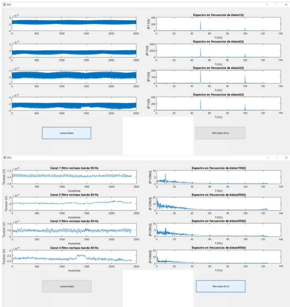
Figura57. Representación de señal de electroencefalografía en el CANAL 2. La figura de arriba sin filtro notch, mientras que la figura de abajo se corresponde con la señal filtrada.
