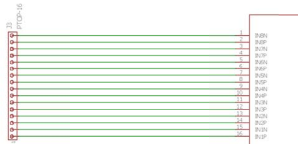
Figura25. Pines de entrada analógicas esquemático Eagle. Vista en detalle de la conexión mediante el conector PTOP de 16 pines, de las entradas analógicas al chip ADS1299.
