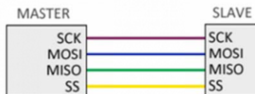
Figura19. Líneas de conexión SPI entre dispositivo Master y dispositivo Esclavo. Obtenido de: [16]
