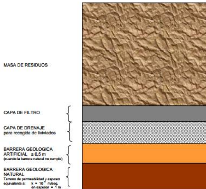
Imagen 18. Propuesta de impermeabilización según el desarrollo técnico del RD 1481/2001
