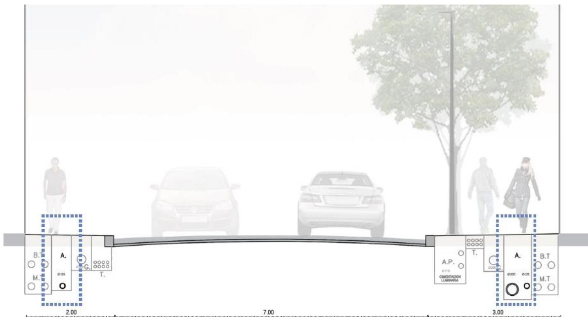
Ilustración 56. Sección esquemática con instalaciones de abastecimiento
