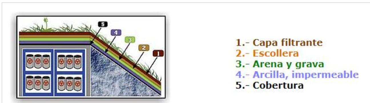
Figura 3.8: Esquema de almacenaje de residuos de El Cabril
