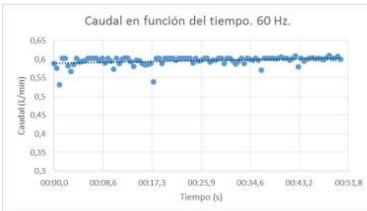
Figura 33: Caudal en función del tiempo con control a 60 Hz
