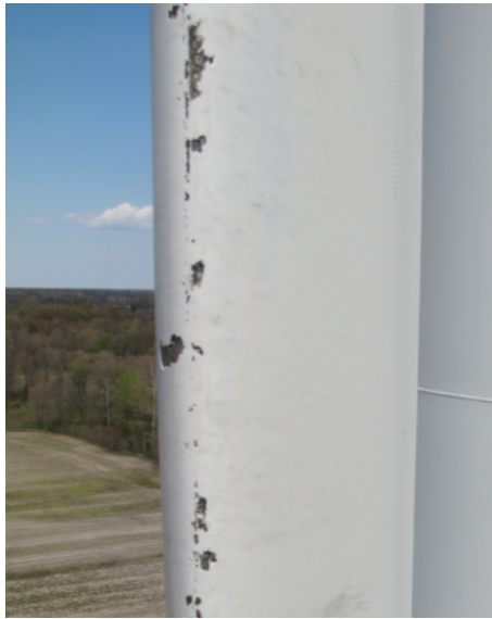
Figura 22: Destrucción desde el interior de una pala por recubrimiento mal procesado
