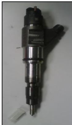
*Fig.1.: Inyector C (Bosch 3-22).*
