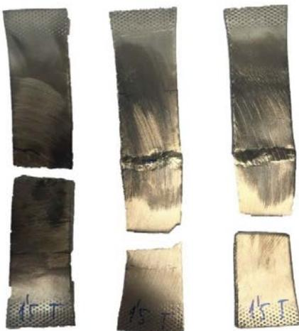
Podemos observar que las probetas rompen por la zona del material base o por la zona del cordón de soldadura indistintamente, por lo que la soldadura es igual de fuerte que el propio material base. Apreciamos un periodo plástico muy grande con respecto al resto de probetas.
