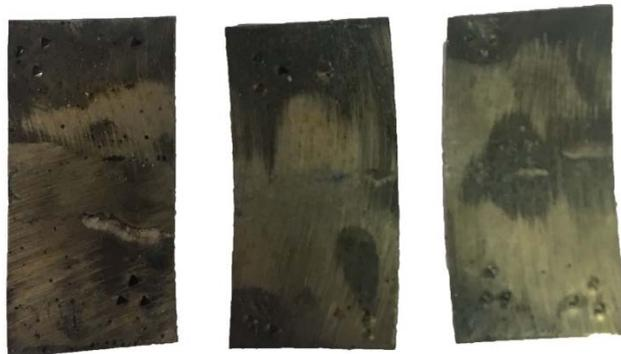
Figura 56 - Probetas AISI316L Laminada hasta 1,00mm tras corrosión húmeda FeCl3
