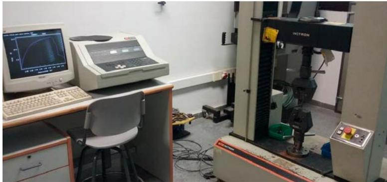
Figura 25 – Máquina de ensayo a tracción Instron 4200, célula de carga de 50kN y ordenador de obtención de resultados
