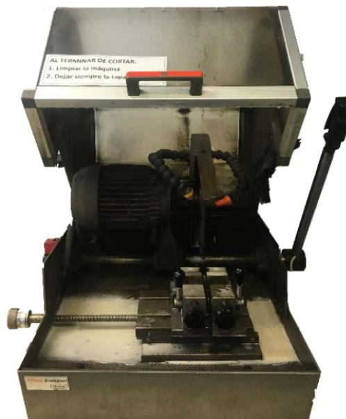
Figura 32 – Sierra de disco con accionamiento manual.
