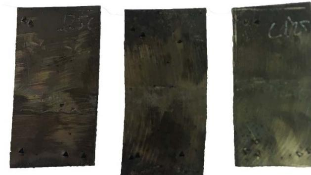
Figura 55 - Probetas AISI316L Laminada hasta 1,25mm tras corrosión húmeda FeCl3
