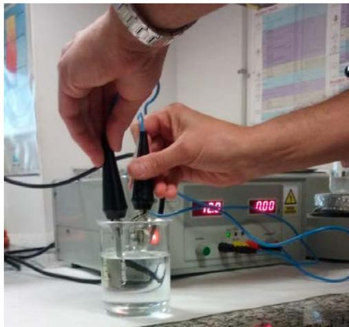
Figura 36 – Ataque electroquímico en disolución de Ácido Oxálico al 20% y tensión de 12V y 1,2Amp.
