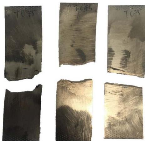
Figura 29 - Probetas de 0,75mm de espesor ensayadas a tracción.
