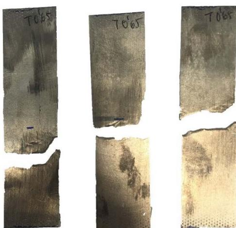
Figura 30 - Probetas de 0,65mm de espesor ensayadas a tracción.
