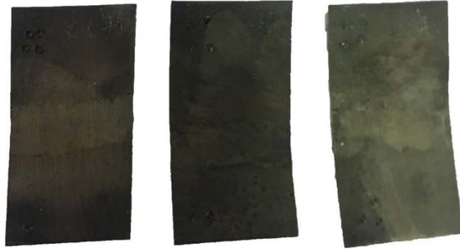
Figura 57 - Probetas AISI316L Laminada hasta 0,75mm tras corrosión húmeda FeCl3
