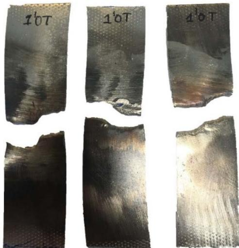
Figura 28 - Probetas de 1,00mm de espesor ensayadas a tracción.
