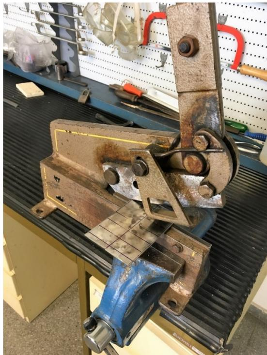
Figura 20 – Herramienta de corte por cizalladura.
