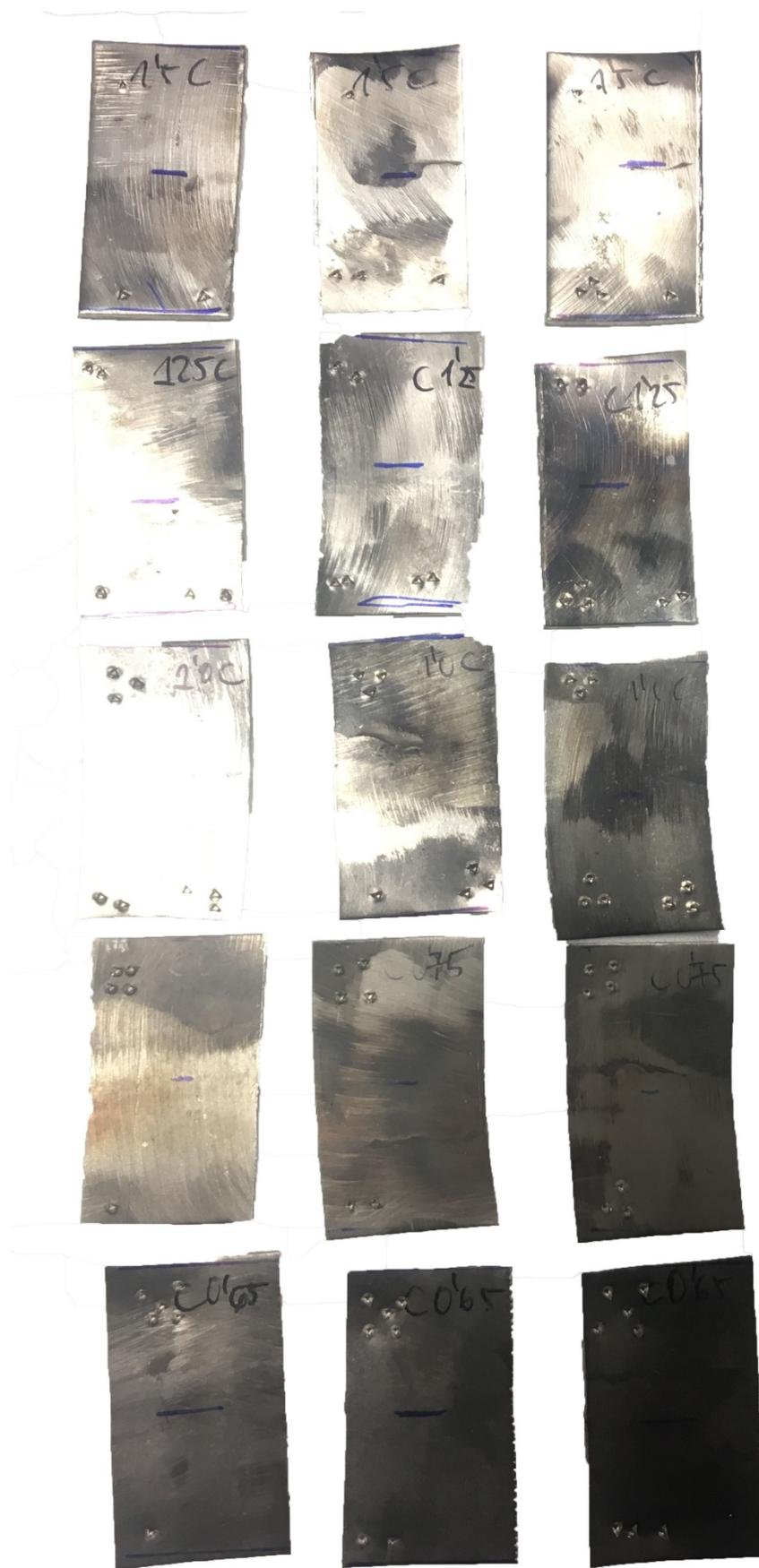
Figura 52 – Probetas antes de ensayar a corrosión
