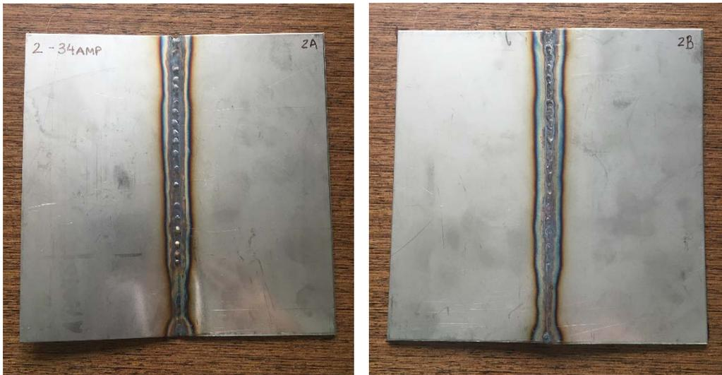
Figura 16 – Cara A y B de la chapa soldada N°2.
