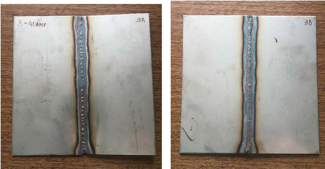
Figura 17 – Cara A y B de la chapa soldada N°3.
