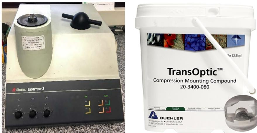
Figura 33 y 34 – Máquina de embutición y compuesto termoendurecible
