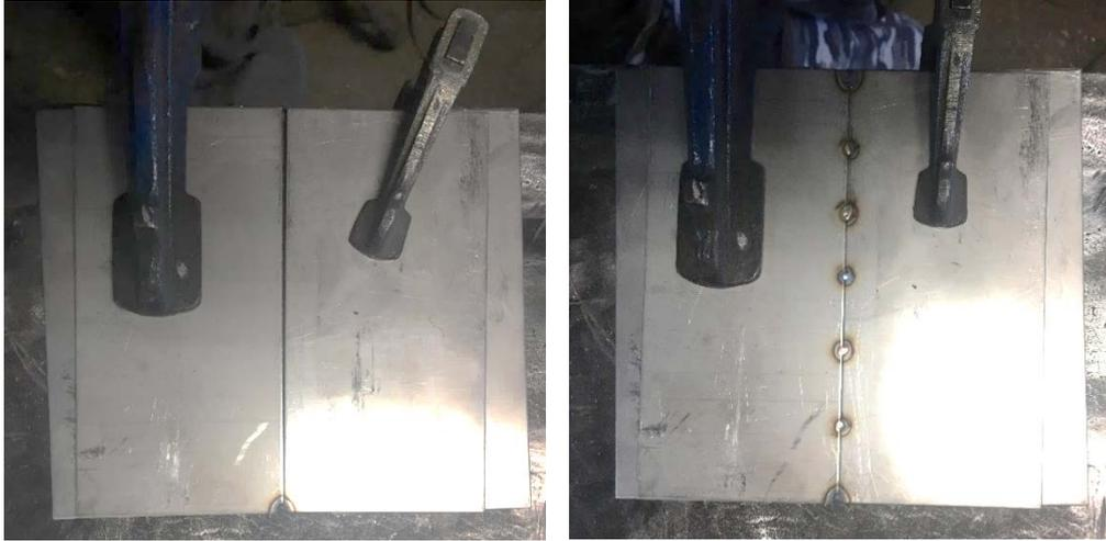
Figura 9 y 10 – Punteado de chapas a soldar.
