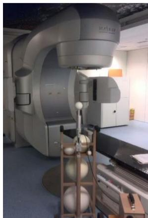
Figura 28: Detector Bonner Sphere midiendo neutrones en un LinAc
