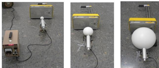
Figura 59: Fuente de neutrones de  $^{241}\text{Am-Be}$  medida con el sistema de esferas Bonner
