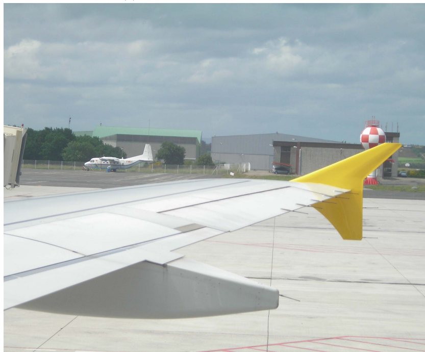
(d) Endplate winglet configuration
