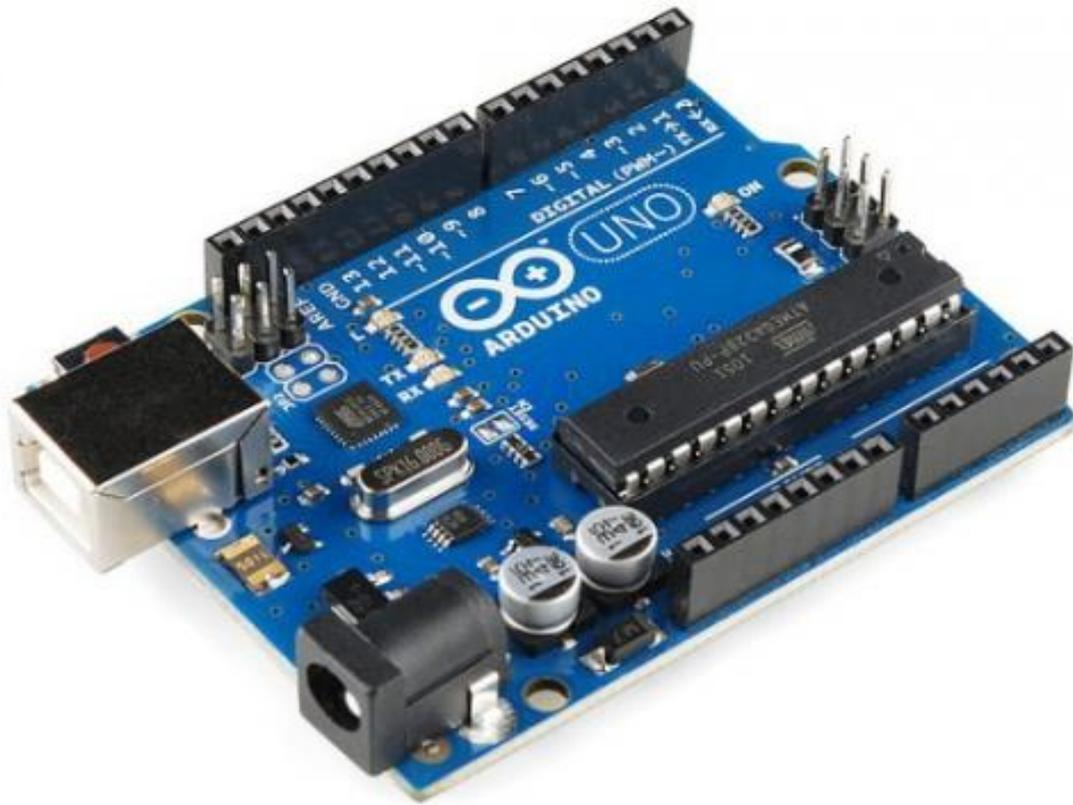
*Ilustración 5. Microcontrolador arduino uno formato DIP*
