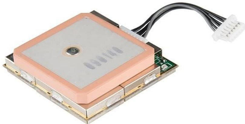
Ilustración 3. Receptor gps
