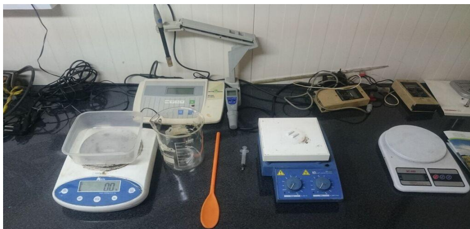
Figura 6. Material necesario para la realización de la formulación; se muestran balanzas, vasos de precipitado, pH-metro.
