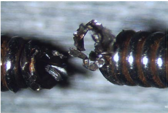
Fig. 38. Microfotografía de cuerda 3D D'Addario sometida 408 h a disolución de sudor concentrado.
