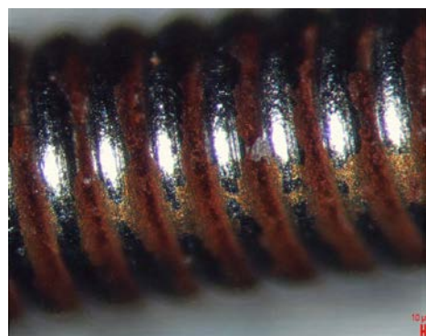
Fig. 31. Microfotografía de cuerda 3D D'Addario sometida 72 h a disolución de sudor concentrado.
