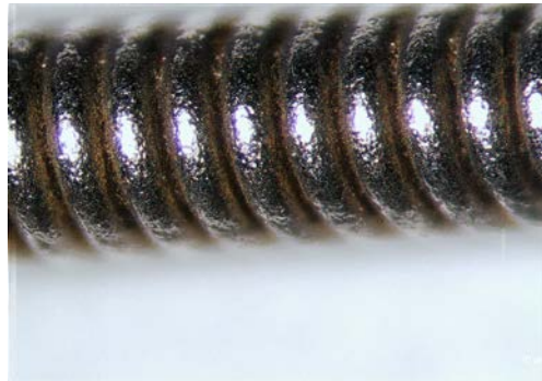
Fig. 31. Microfotografía de cuerda 3D D'Addario sometida 72 h a disolución de sudor concentrado.
