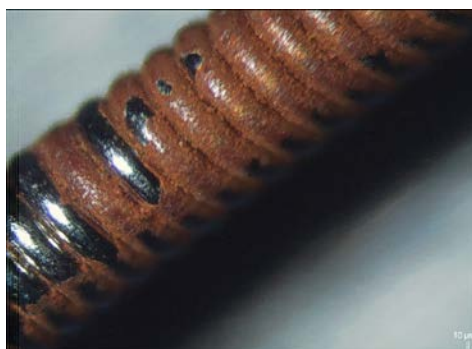
Fig. 32. Microfotografía de cuerda 3D D'Addario sometida 168 h a disolución de sudor concentrado.
