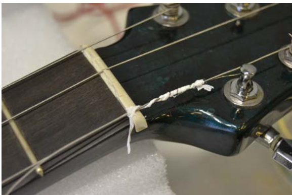
Fig. 12. Fotografías del montaje experimental en la fase de protección catódica: (a) fuentes de alimentación. (b) anclaje del extremo inferior de cuerdas aisladas individualmente mediante Teflón. (c) anclaje superior de las cuerdas al clavijero. (d) fijación del extremo de la cuerda (cátodo) que se introducirá en la disolución de nitrato potásico
