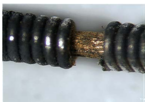
Fig. 33. Microfotografía de cuerda 3D D'Addario sometida 336 h a disolución de sudor concentrado.
