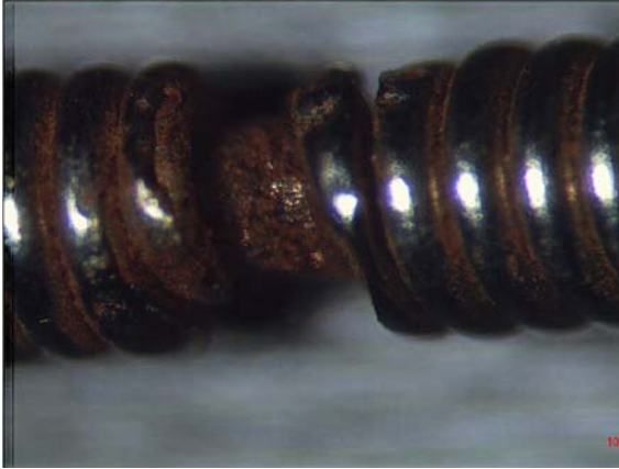
Fig. 36. Microfotografía de cuerda 3D D'Addario sometida 408 h a disolución de sudor concentrado.
