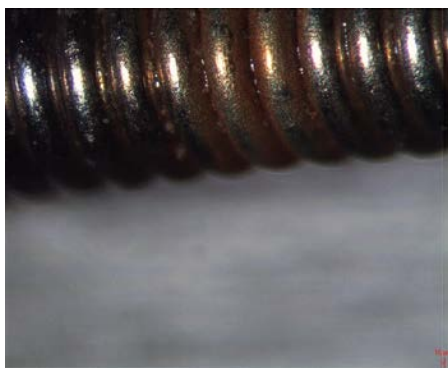
Fig. 32. Microfotografía de cuerda 3D D'Addario sometida 168 h a disolución de sudor concentrado.
