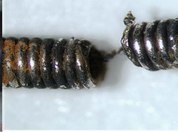
Fig. 37. Microfotografía de cuerda 3D D'Addario sometida 408 h a disolución de sudor concentrado.
