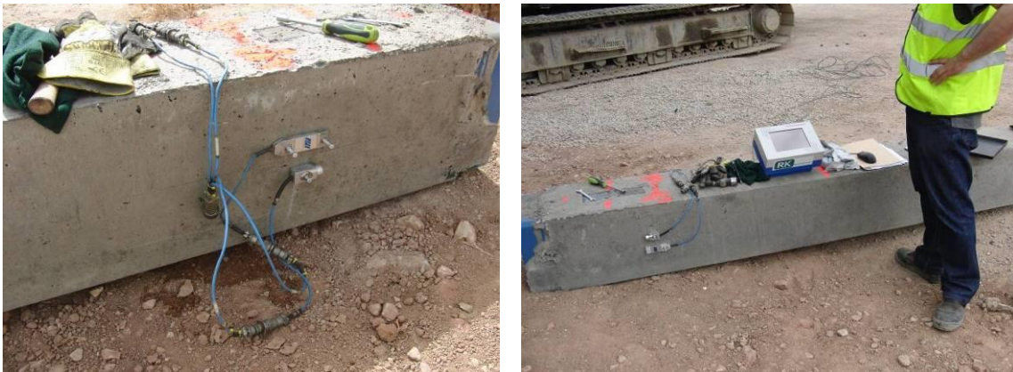
Figura IV-46: Instalación en el pilote de acelerómetros y extensómetros para realizar el ensayo P.D.A.
