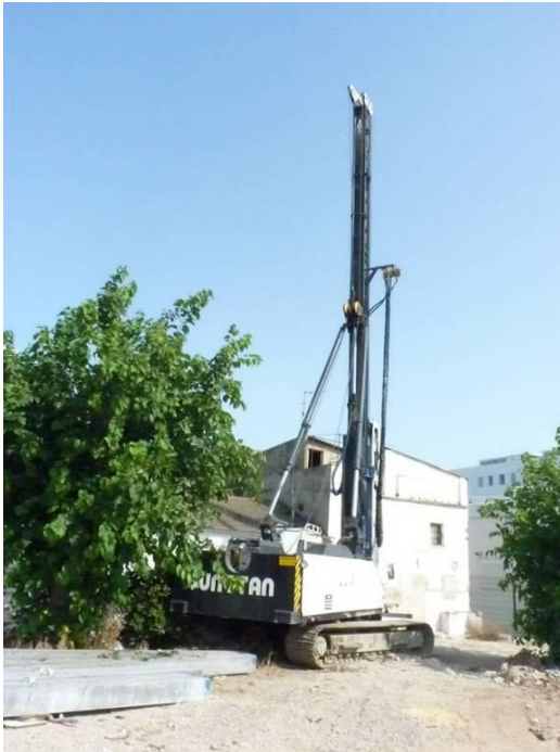
Figura IV-32: Junttan PM-20 con martillo de 7 t
