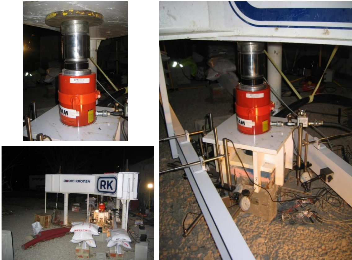
Figura VI-2. Sistema de aplicación de cargas y detalle de la célula de carga de 120 t
