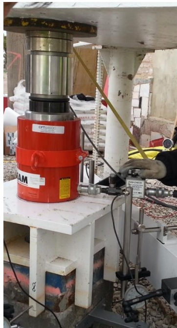
Figura IV-79. Célula de carga situada entre el bastidor y el gato hidráulico
