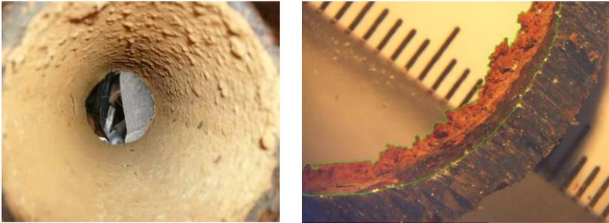
Figura A.2.2.1 Cambio de las condiciones físicas internas de una tubería con su uso
