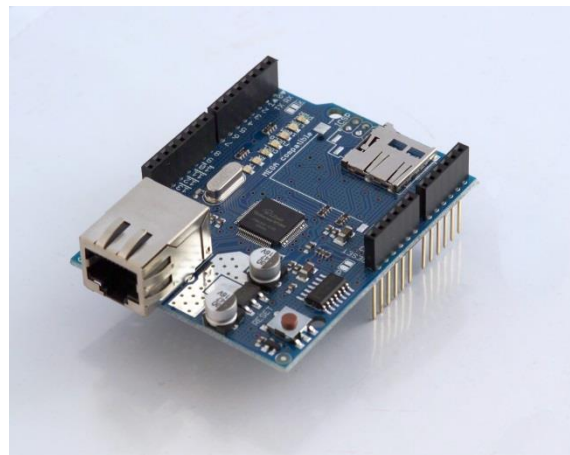
Figura 4.4: Arduino® Ethernet Shield, para disponer de un Arduino® con conexión a redes Ethernet [7].
