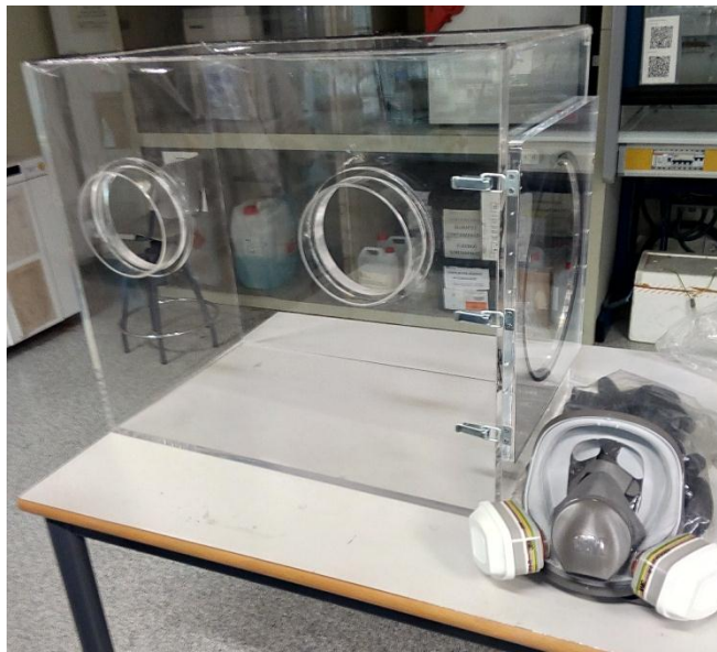
Figura 7 - Cabina de nanopartículas del Centro de Biomateriales e Ingeniería Tisular UPV
