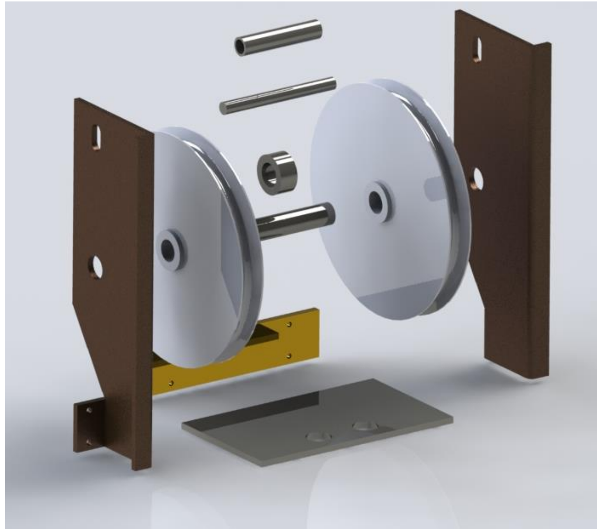
Ilustración 61. Explosión, Conjunto de poleas con sus componentes.
