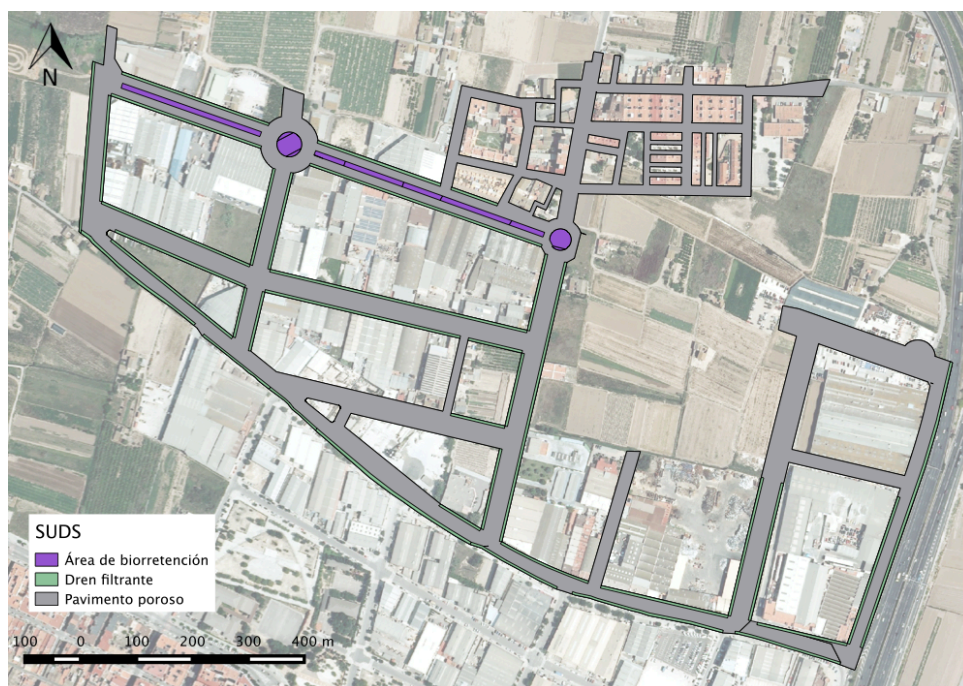
Ilustración 21. Vista general de los SUDS propuestos
